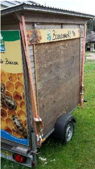
Nachdem die Hintertür geöffnet wurde geht man in das Bienenmobil und entriegelt den oberen Teil der Holzvorderwand und greift dann außen an die dort angebrachten Griffe (siehe Bild) und nimmt die Holzwand heraus. Das gleiche erfolgt mit der unteren Holzwand, deren Griffe im Unterteil befestigt sind.
